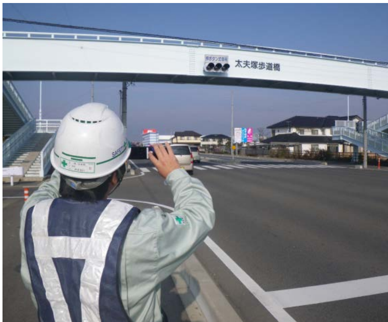
現場状況写真撮影GPS付き携帯電話
